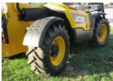
**L**e pneu Continental AC70G MPT, destiné à équiper les télescopiques et chargeuses à pneus, convient autant sur route que dans les champs. La très large surface de portance des barrettes, sa carcasse renforcée, sa ceinture
